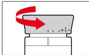
С помощью коррекции диоптрий вы можете настроить резкость прицельной марки и индикации в соответствии с вашими предпочтениями.
